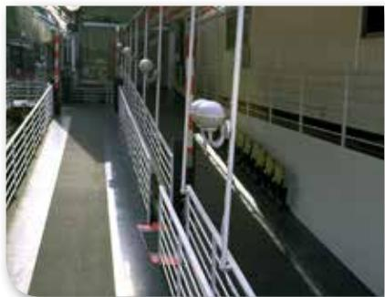
**Описание:** Противоскользящий ковер, изготовленный из поливинилхлорида с минеральным покрытием (оксид алюминия).
